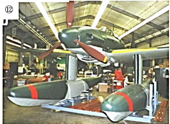
⑪⑫移動用台車に搭載終了、これから細部の点検と仕上に入る
