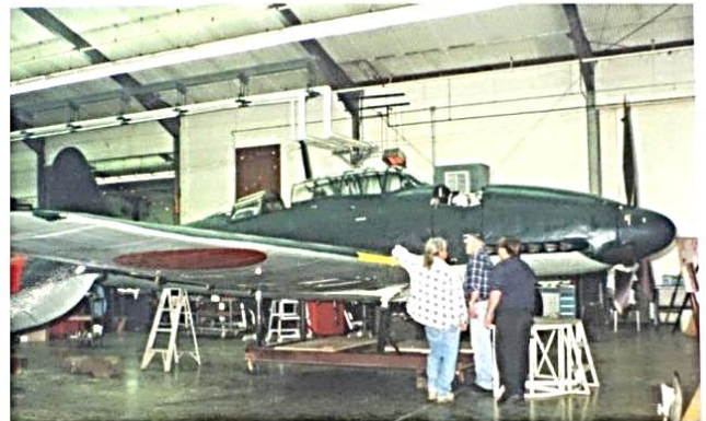
①架台上の胴体に左右の主翼が組付けられた
