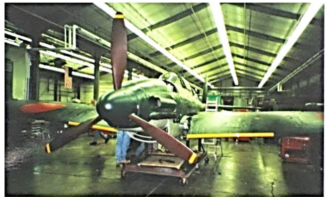
②この状態では、架台の胴体受け脚が干渉し、主翼のチルト可能範囲は15度位である
