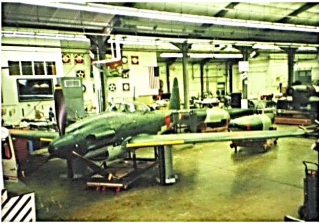
⑤左右の脚柱の結合終了
