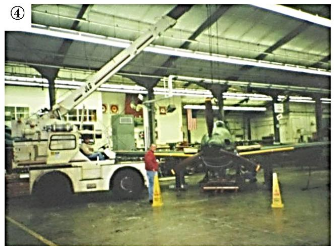
③④3点式の吊上げ金具を用い吊上げに入った
