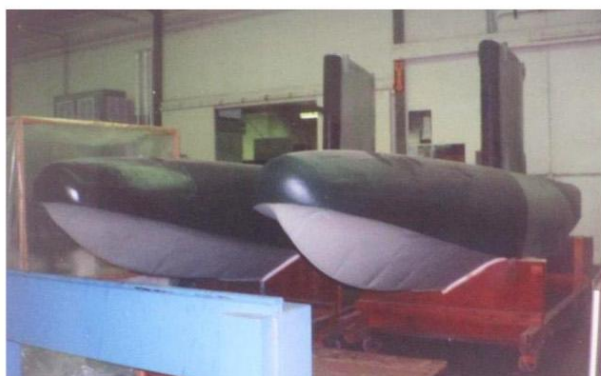
⑦塗装中の浮舟と脚柱、赤帯（プロペラ危険防止）、白帯（台車受け位置）が入る
