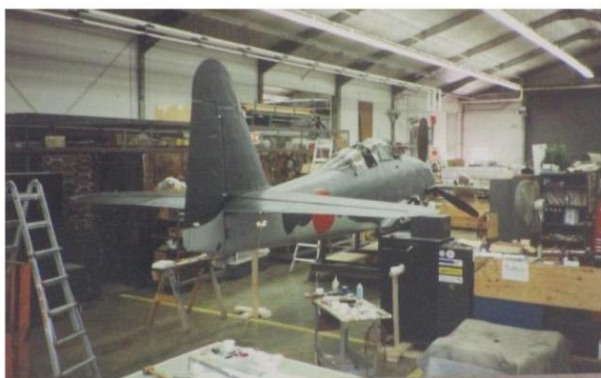
⑪方向舵と昇降舵の組付けが終了し、尾部翼の展張を行った胴体
