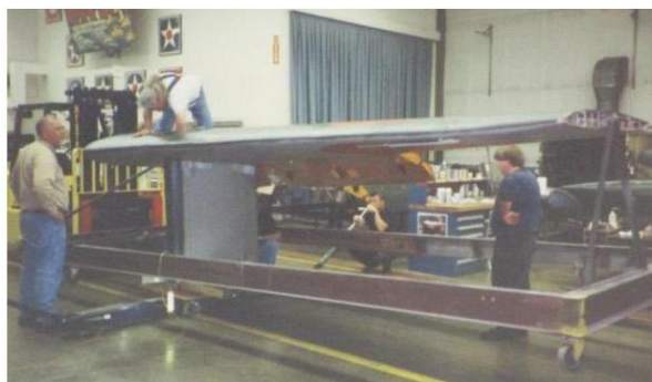
⑨主翼と脚柱の結合トライ、後縁部に親子フラップが下がっている
