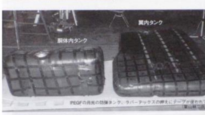
⑤夜間戦闘機月光の胴体内と主翼内外袋式防弾タンク
