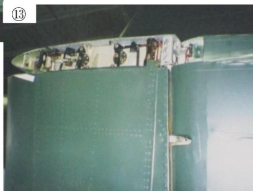
⑫、⑬尾部翼の手動折畳展張機構
