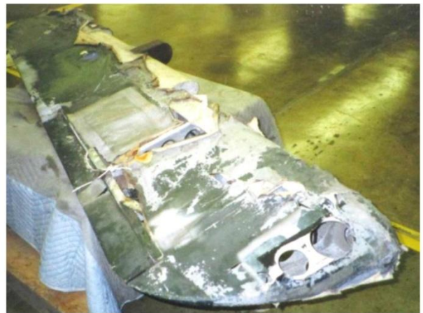
⑤腐食の酷い方向舵
