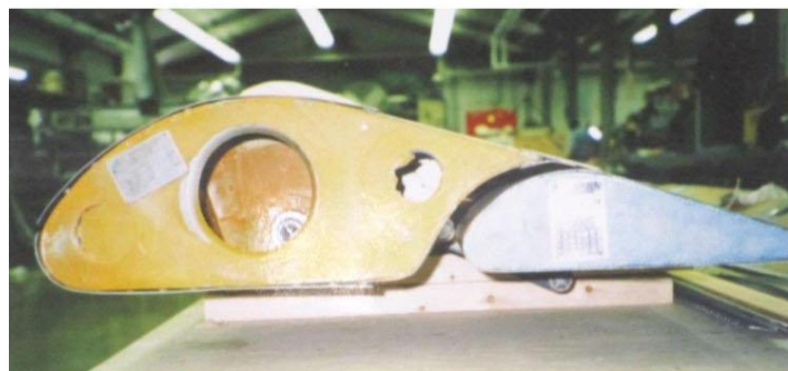
⑤、⑥ 修復中の親子式フラップ、暗緑色が剥がれ、試作機の黄色が露出
