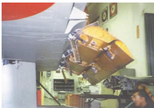
⑧ 組立中の 28 号機、親子式フラップの構造に注意
