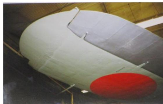
⑪ 左翼のエルロン下面、羽布張り構造
