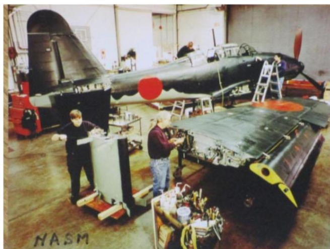
⑤、⑥ 修復中の親子式フラップ、暗緑色が剥がれ、試作機の黄色が露出
