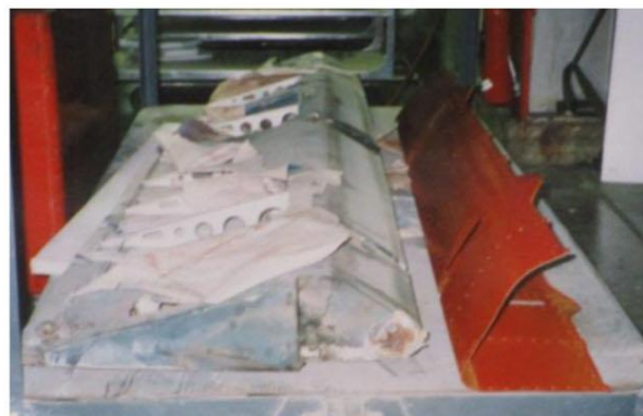
⑩ 腐食の進行したエルロン、前縁部はジュラルミン張り D ボックス構造
