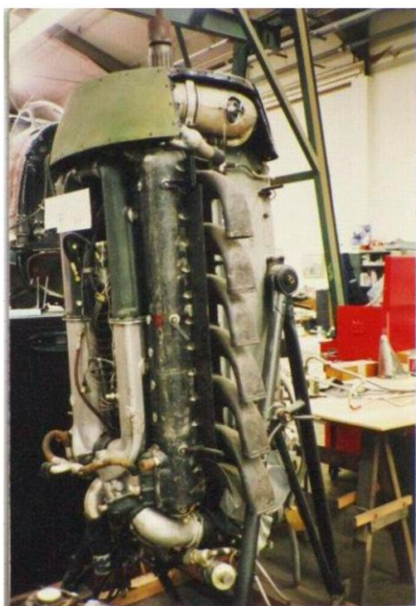
⑦胴体から外され、洗浄されたアツタ 32 発動機
