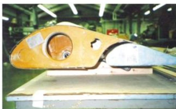
⑥、⑦親子式フラップの濃緑色塗装が剥げ、下から試作機色の黄色（C1）が出ていた
