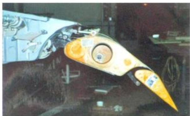
⑥、⑦親子式フラップの濃緑色塗装が剥げ、下から試作機色の黄色（C1）が出ていた
