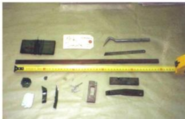
④28号機の機内から発見された不用残留物
