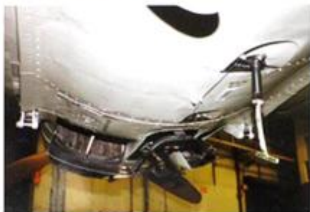
⑦28 号機胴体下面、懸吊架詳細、大型爆弾及び魚雷投下器
