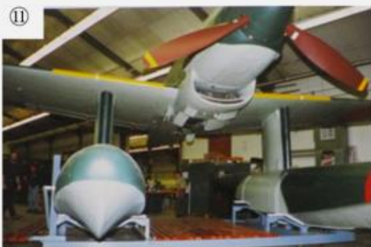
⑪、⑫装着された浮舟（フロート）、チャイン形状とステップ段差が空中と水上性能を左右する
