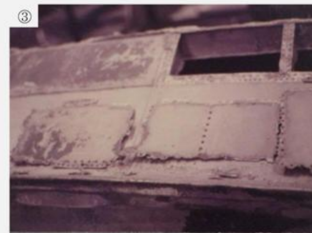
②、③腐食の進行した外板とキール
