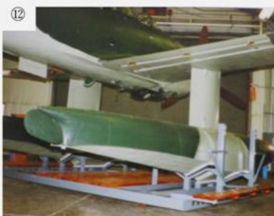
⑪、⑫装着された浮舟（フロート）、チャイン形状とステップ段差が空中と水上性能を左右する
